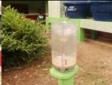
Figura 34 - Construção do pluviômetro alternativo para monitoramento do regime pluvial
