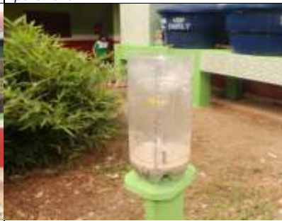
Figura 48 - Construção do pluviômetro alternativo para monitoramento do regime pluvial
