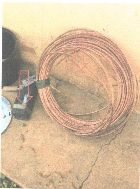
**Foto 5.09** – Cadinho e cordoalha de cobre utilizados no aterramento.
